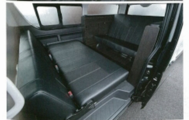
3列目のシートはこのように収納式を採用。これにより4列目のシートが前方まで移動できるのだ
