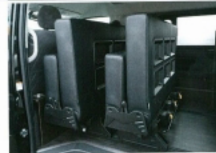
REVVOシートはバタフライタイプのフラットシートを採用する。そのため、ロングスライドレールにより、ここまでシートは折り畳むことができる
