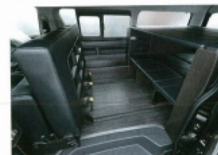
REVVOシートはバタフライタイプのフラットシートを採用する。そのため、ロングスライドレールにより、ここまでシートは折り畳むことができる
