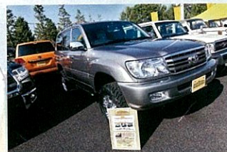
2002年式FJ105はオーストラリア仕様のランクル100。フロントサスはコイルリジッドを採用し、タフな足回りを持つモデル。
