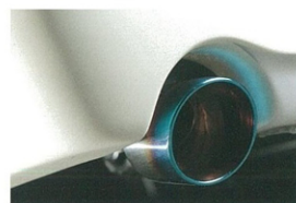
●リヤビューを引き締めるのは、415コブラのヒートシールド。青銅色に焼けたカール巻きのテールエンドがグリップを醸す。リヤバンパーも415コブラだ
