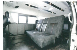
●セカンドシートは幅1300mmのT-REVO。生地は415コブラのシートカバーに合わせてアルカンターラレッドステッチで張り替え
