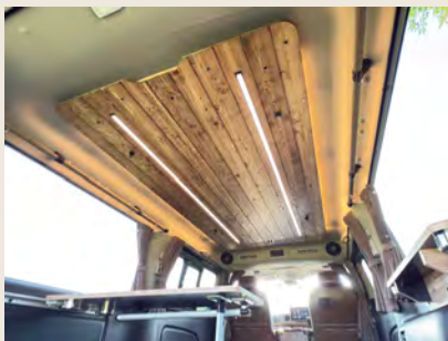
天井ウッドパネル（ダウンライト+間接照明）
