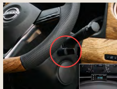
PIVOT オールクルーズコントロール (3DA-X) ディーゼル車にもオートクルーズ後付け可能 ※追従・自動減速はしません
