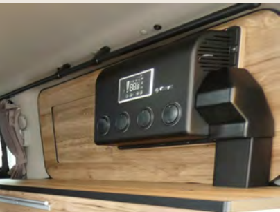
12V クーラー（外部電源 SET） エンジン停止中も外部電源又はポータブル電源にて稼働 本体は右リアガラス部、室外機はスペアタイヤ部へ設置 ¥495,000
