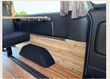
ベッドエクステンション ベッド両脇の隙間を埋める延長ベッド+家具 助手席側は純正トリムを加工設置 ※オートスライド有無により寸法が異なります
