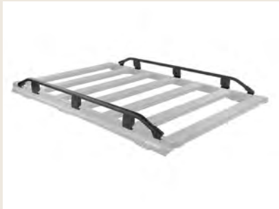
BASE RACK 用ガードレール 長さ 2,995 m、高さBASERACKより約 94 mmアップ
