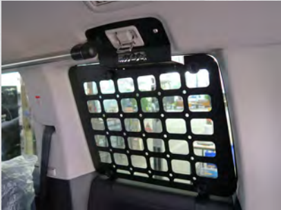
IPF サイドストレージパネル左右 角穴と丸穴の開いたパネルにより小物の収納が可能
