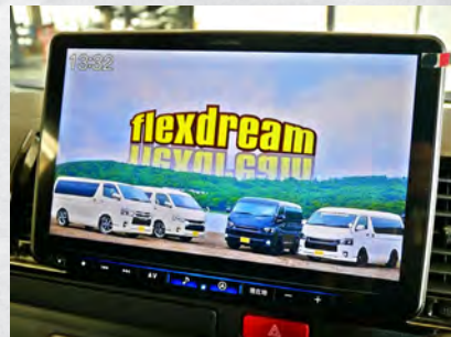
ナビ変更：ALPINE BIG-X 11型フローティングナビ フルメディアモデル (XF11NX2)
