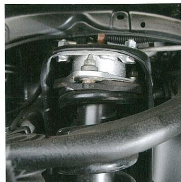
インテルコのマッドタイヤを履かせるために、2インチのリフトアップを施した。四駆らしさが強調されるだけでなく、アウトドアで荒れ地を走る際にもフロアに空間を確保できるので、これによる効果は絶大!
