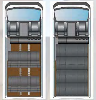
左：ドライビングレイアウト 右：フルフラットレイアウト
