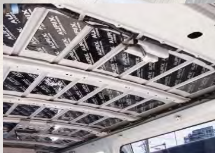
FD制振・断熱施工 ・・・¥253,000
