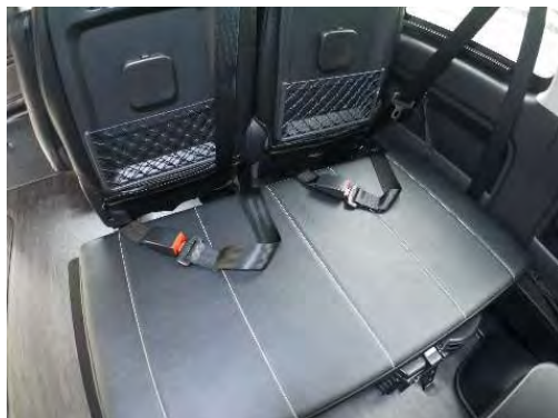
ベッドキット兼補助席。 2017年7月法規対応モデルの 後向き2名乗車席。
