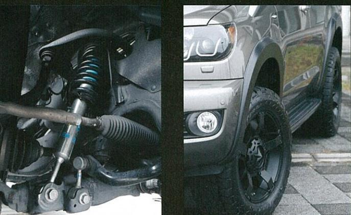
前後ともショックはビルシュタイインに交換。フロントは5100タイプで、スプリングシートのCリングを調整する事で、ノーマルスプリングのまま車高調整が可能だ。
