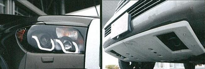
アンダーガードはタンドラの純正を流用。ある意味兄弟車的と言えるだけに、サイズ的にもポジション的にも違和感なく装着できる。ヘッドライトはイーグルアイのプロジェクトタータイプに変更。スマートランプがU字型になっており、非常に個性的なソラ構えとなっている。併せてヘッドライトのHID化も施されている。
