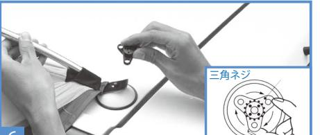
テープの上に三角ネジを取り付け、適度に締め付けてください。
