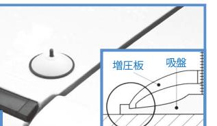
増圧板を吸盤の上にセットし、吸盤のフチの内側に増圧板がしっかりと入っているか確認してください。
