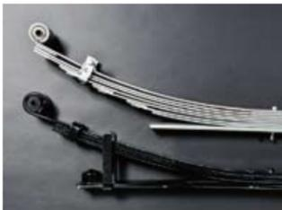
●純正リーフの4枚構成に対し、8枚の板バネで構成する。1枚ずつの板厚を薄くすることで、しなやかにストロークしながらも、「コン」のある乗り心地を生み出すのである
