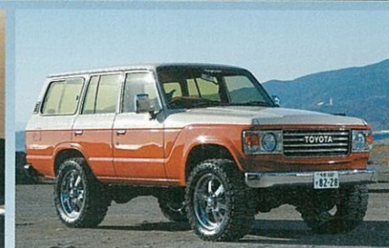
1989年式のトヨタ・ランドクルーザー。こちらもハイルーフをロールーフにコンバージョンしている。2インチ上げられた車高に、33×13.5R20のタイヤサイズでアメリカな存在感は抜群だ。
