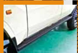
独特の質感を持つLINE-Xはドレスアップ塗装やオフロードでのバンパーのキズ予防などに最適だ。フレックスドリームのデモカーでもある、ランクル70ピックアップは、荷台のほかにも、ARBバンパーやサイドステップにも施工。ツルツルした表面からザラついたマット塗装に変わること、実にヨウクらしいハードなエクステリアを演出する。エクステリアに塗装したカラーはブラックだが、ベッドライナーにはボディカラーにマッチングさせたベージュを使用。そう、カラーバリエーションは270色! あえてボディ同色にして質感の違いで個性を表現するもよし、全く異なる色でカラーリングの妙を楽しむもよし!
