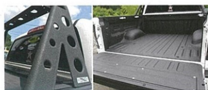
荷台やスポーバーにLINE-Xを直接スプレーすることで、隙間がでず錆びないといった利点もあり。耐衝撃、耐酸腐などに加え滑り止め効果も期待でき、見た目とタフさを同時に向上。
