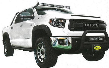
荷台やスポーバーにLINE-Xを直接スプレーすることで、隙間がでず錆びないといった利点もあり。耐衝撃、耐酸腐などに加え滑り止め効果も期待でき、見た目とタフさを同時に向上。
